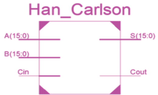
Figure 25. RTL Schematic of Han Carlson
